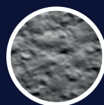
CSP 7 (Granallado intenso)
